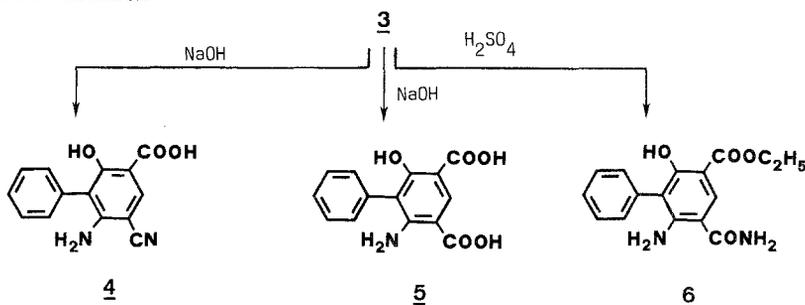
Neben diesen Hydrolysereaktionen ermöglicht die Aminogruppe von **3** die Herstellung entsprechend halogensubstituierter Produkte. In einer *Sandmeyer*-Reaktion entsteht demnach der 6-Chlor- und 6-Brom-carbonsäureester **7a, b**. Analog zu **5** ließ sich **7a** zur Dicarbonsäure **8** hydrolysieren. Über Reaktionen an der Hydroxygruppe soll zu einem späteren Zeitpunkt gesondert berichtet werden.
